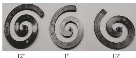
图3 50%GF增强PBT/PC复合材料与PA6复合材料的加工流动性(注塑)
